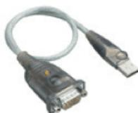
*Рис. 11. Адаптер Tripp-Lite USB/Serial DB-9*
