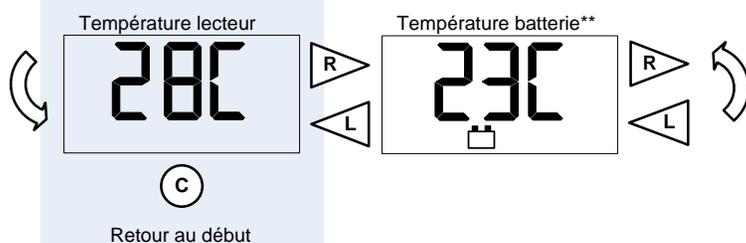
\*\* Si une sonde de température à distance est raccordée au SunSaver Duo, la valeur affichée est la température de la sonde. Sinon, la température de batterie est la température ambiante du SunSaver Duo, mesurée par la sonde de température locale.
