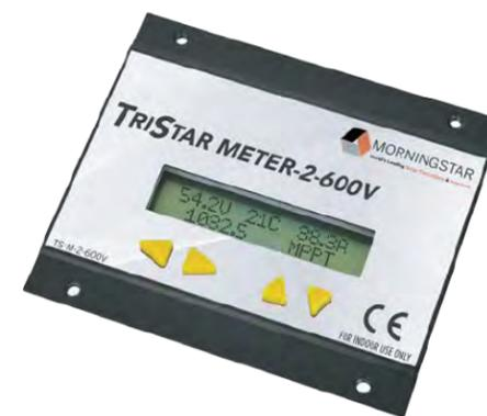
Bordeigenes Hightech-Digital-Display für den Regler TriStar MPPT 600 V. Anzeige umfangreicher Daten zu Anlage und Regler, von Datenprotokollen, Messwerten als Balkendiagramm sowie von Warnhinweisen und Fehlermeldungen als Unterstützung bei der Fehlerbehebung.
