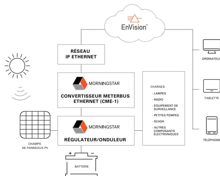
Le convertisseur MeterBus Ethernet (modèle : CEM-1) permet une connexion Internet et réseau IP à tous les produits MorningStar dotés d'un port MeterBus existant (RJ-11) comprenant :
