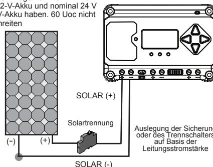
Schließen Sie die Leitungen der (PV-)Solaranlage bei geöffnetem Solar-Trennschalter an die Solarklemmen des EcoPulse an. Seien Sie vorsichtig, da die Solaranlage im Sonnenlicht stets Strom produziert. **DER TRENNSCHALTER DARF ZU DIESEM ZEITPUNKT NICHT GESCHLOSSEN WERDEN.**
