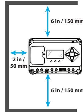
Abbildung 3.1 – Korrekte Abstände für passive Kühlung
