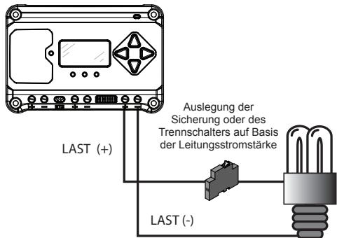
Schalten Sie die Last ab und verbinden Sie die Lastleitungen mit den Lastklemmen. **DIE SICHERUNG ODER DER TRENNSCHALTER DÜRFEN ZU DIESEM ZEITPUNKT NICHT GESCHLOSSEN WERDEN.**
