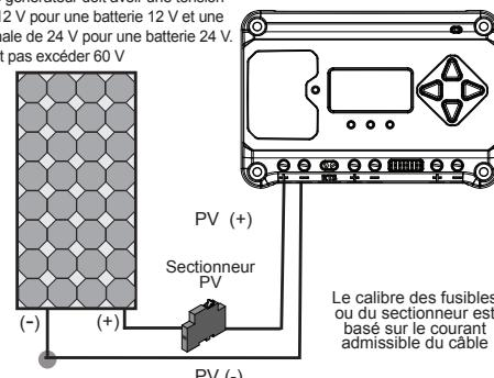
Raccordez les câbles du générateur solaire (PV) aux bornes PV de l'EcoPulse en maintenant le sectionneur PV ouvert. Soyez prudent car le générateur PV produit du courant dès qu'il est exposé au soleil. NE FERMEZ PAS LE SECTIONNEUR À CETTE ÉTAPE.
