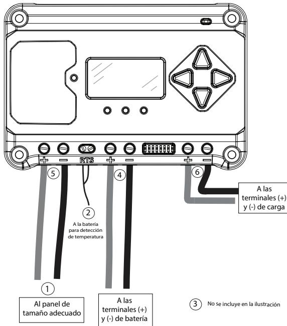
Figura 3-2. Realizar el cableado del EcoPulse
