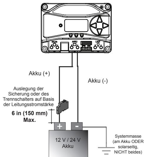
Stellen Sie sicher, dass die DIP-Schalter 2 und 3 für 12 oder 24 V eingestellt sind, wie in Abschnitt 3.2 beschrieben.
