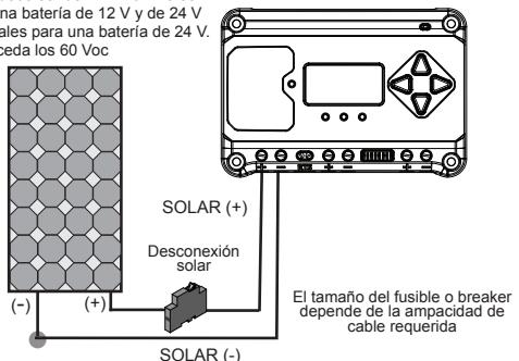
Con la desconexión solar abierta, conecte los cables del panel solar (fotovoltaico) a las terminales solares del EcoPulse. Tenga cuidado, ya que el panel solar producirá corriente cada vez que esté expuesta a la luz del sol. NO CIERRE LA DESCONEXIÓN EN ESTE MOMENTO.
