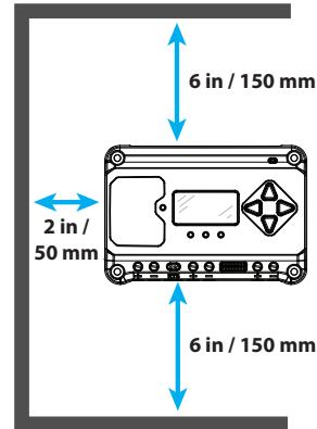
Figure 3-1. Espacements requis pour le refroidissement passif
