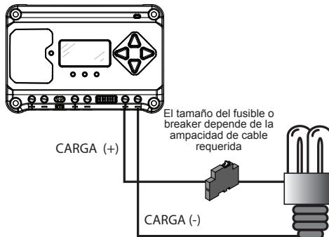
Apague las cargas y conecte los cables de carga a las terminales de carga. NO CIERRE EL FUSIBLE NI EL BREAKER MIENTRAS LLEVA ESTO A CABO.
