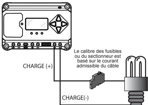
Éteignez les charges et connectez les câbles de charge aux bornes de charge. NE FERMEZ PAS LE COMPARTIMENT À FUSIBLES OU LE SECTIONNEUR À CETTE ÉTAPE.
