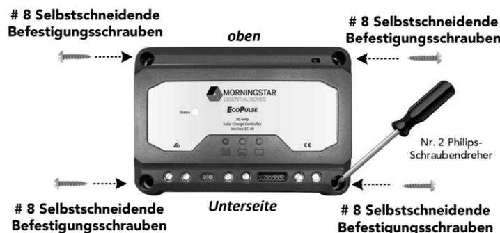
1. Setzen Sie in jedes Montageloch eine selbstschneidende Schraube ein.
