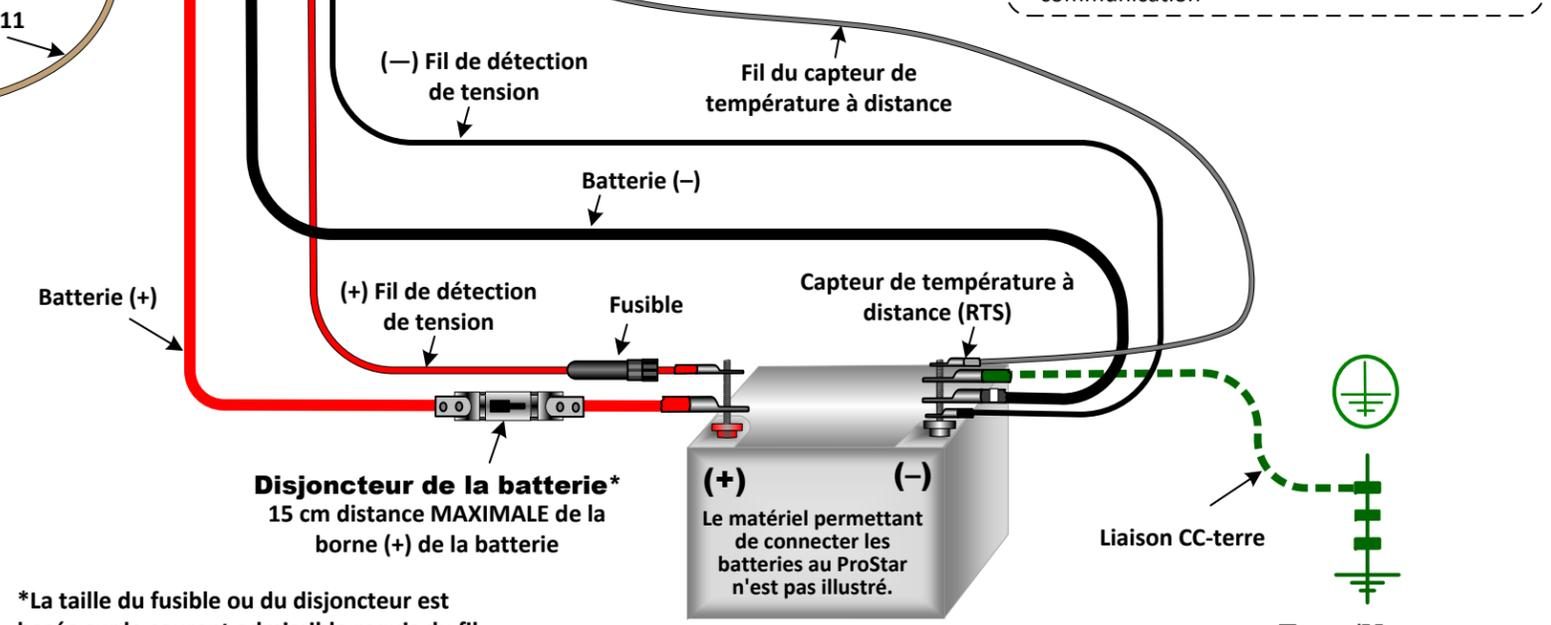
\*La taille du fusible ou du disjoncteur est basée sur le courant admissible requis du fil.
