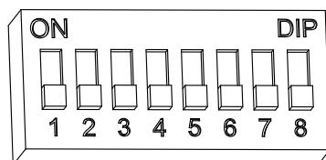
Abbildung 3.1. DIP-Schalterblock zum Einstellen der Ladeparameter
