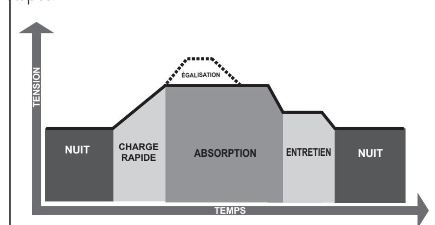
Figure 4-1. Algorithme de charge de l'EcoBoost MPPT
