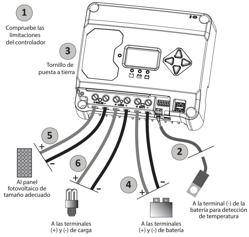
Figura 3-3. Cableado del EcoBoost MPPT
