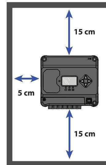
Figure 3-2. Espacements requis pour le refroidissement passif
