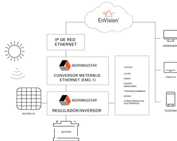
El conversor Ethernet MeterBus (modelo: EMC-1) permite conectividad de Internet y red basada en una IP para cualquier producto de Morningstar que cuente con un puerto MeterBus existente (RJ-11), incluyendo:
