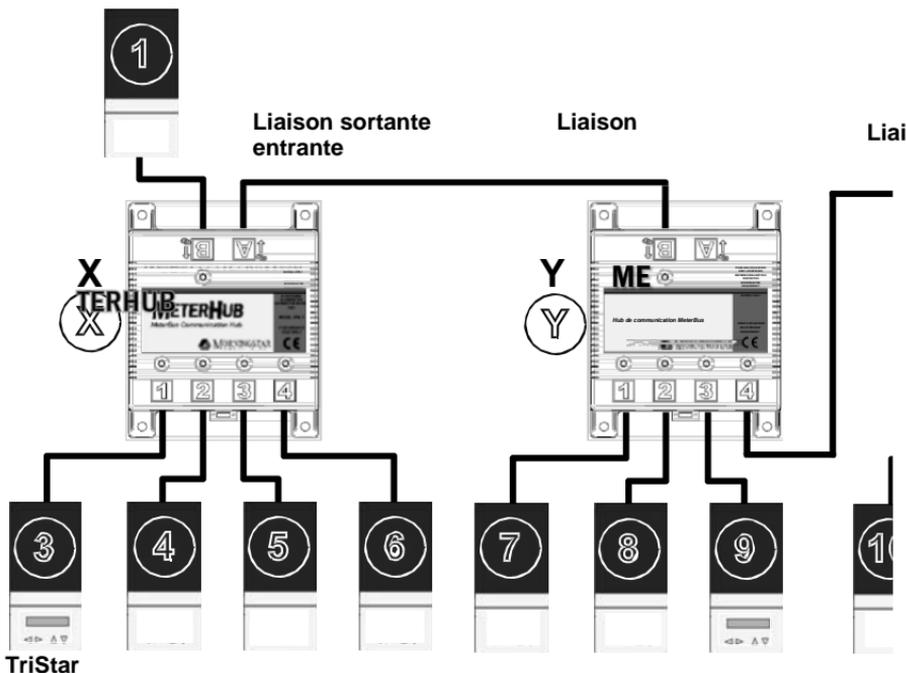
Figure 5. Réseau contenant plusieurs Meter Hubs
