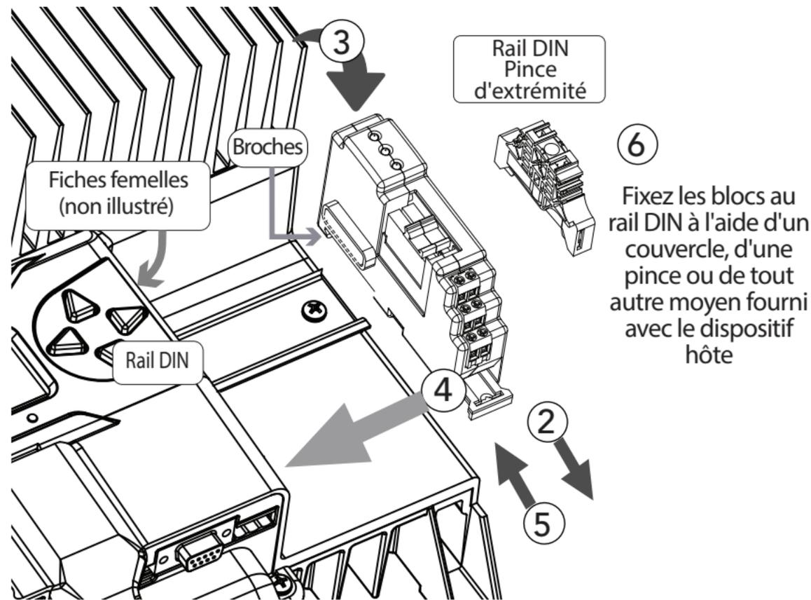
Figure 3-1. Détails d'installation du ReadyRelay
