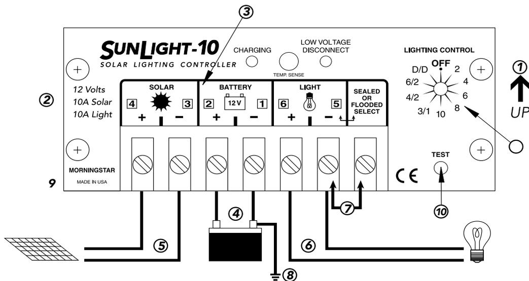
6. Die **LICHT**-Klemmen werden zuletzt angeschlossen. Falls der rote Dioden-Leuchtmelder leuchtet, ist die Batterieleistung niedrig, und die Batterie sollte vor der Beendigung der Installation aufgeladen werden (siehe Abschnitt 6.4).
